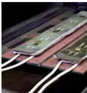
Verwendung von Heizmatten
